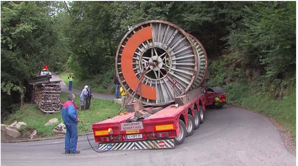
Abb. 33: Kabeltransport für eine Verkabelung einer Hochspannungslleitung
