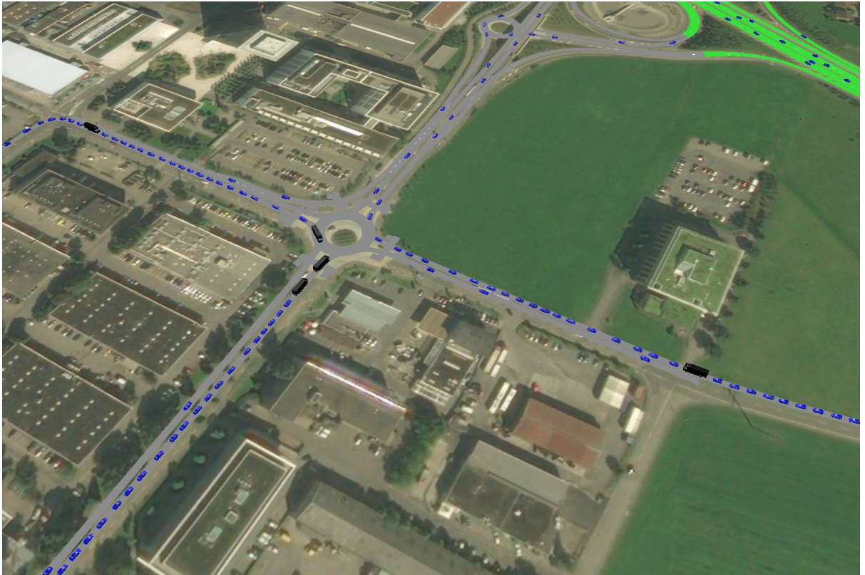
Abbildung 25 Staubildung gemäss Vissim beim Kreisell «Forren», Referenzzustand 2030 ASP
