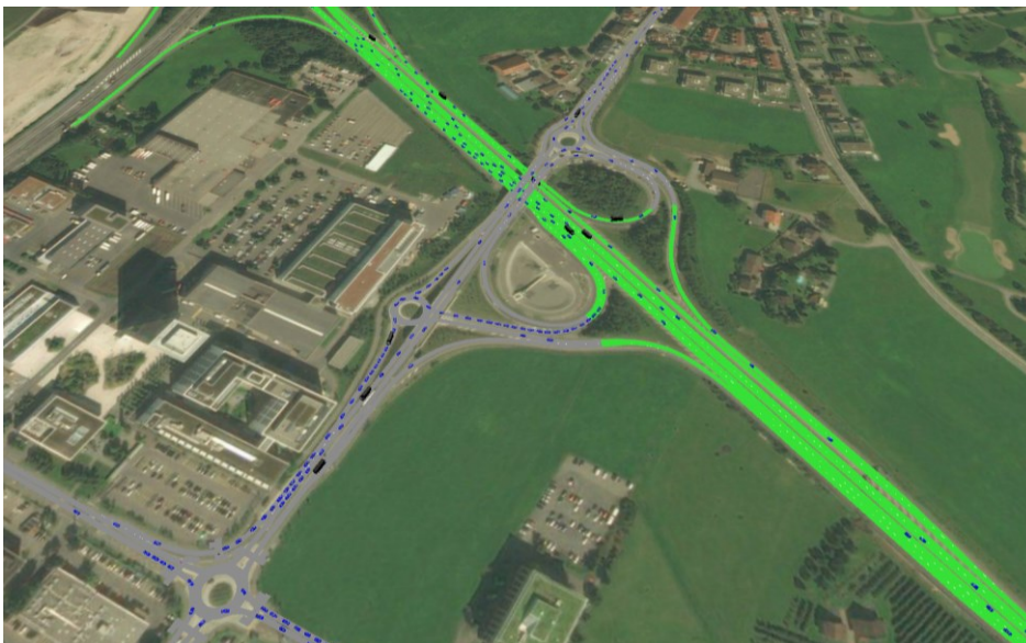
Abbildung 16 Beginnender Rückstau gemäss Vissim im Verflechtungsbereich zwischen Kreisel «Anschluss Süd» und Kreisel «Forren», Referenzzustand 2030 MSP
