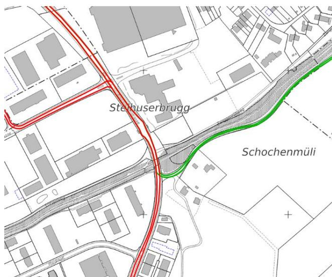
Abbildung 1: ZVB, Fahrzeuglänge 25 m (rot), Fahrzeuglänge 18 m (grün)
