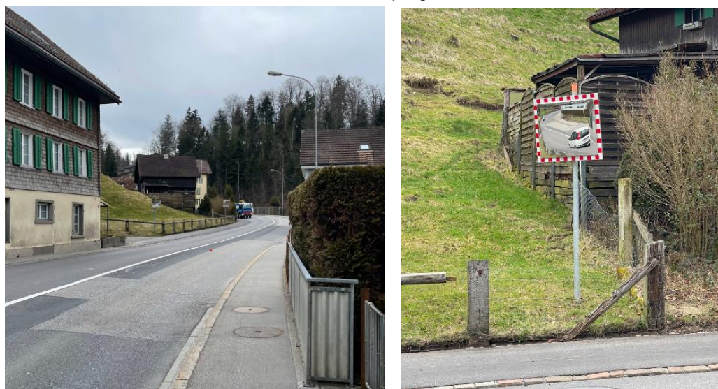
Abb. 10 und 11: bei ungenügenden Sichtverhältnissen werden Verkehrsspiegel eingesetzt
